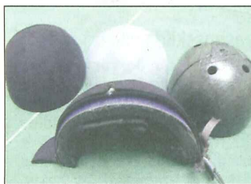
Hemligheten ligger innanför skalet, ett glidskikt gör att stötupptagningen vid ett snett slag blir bättre.
