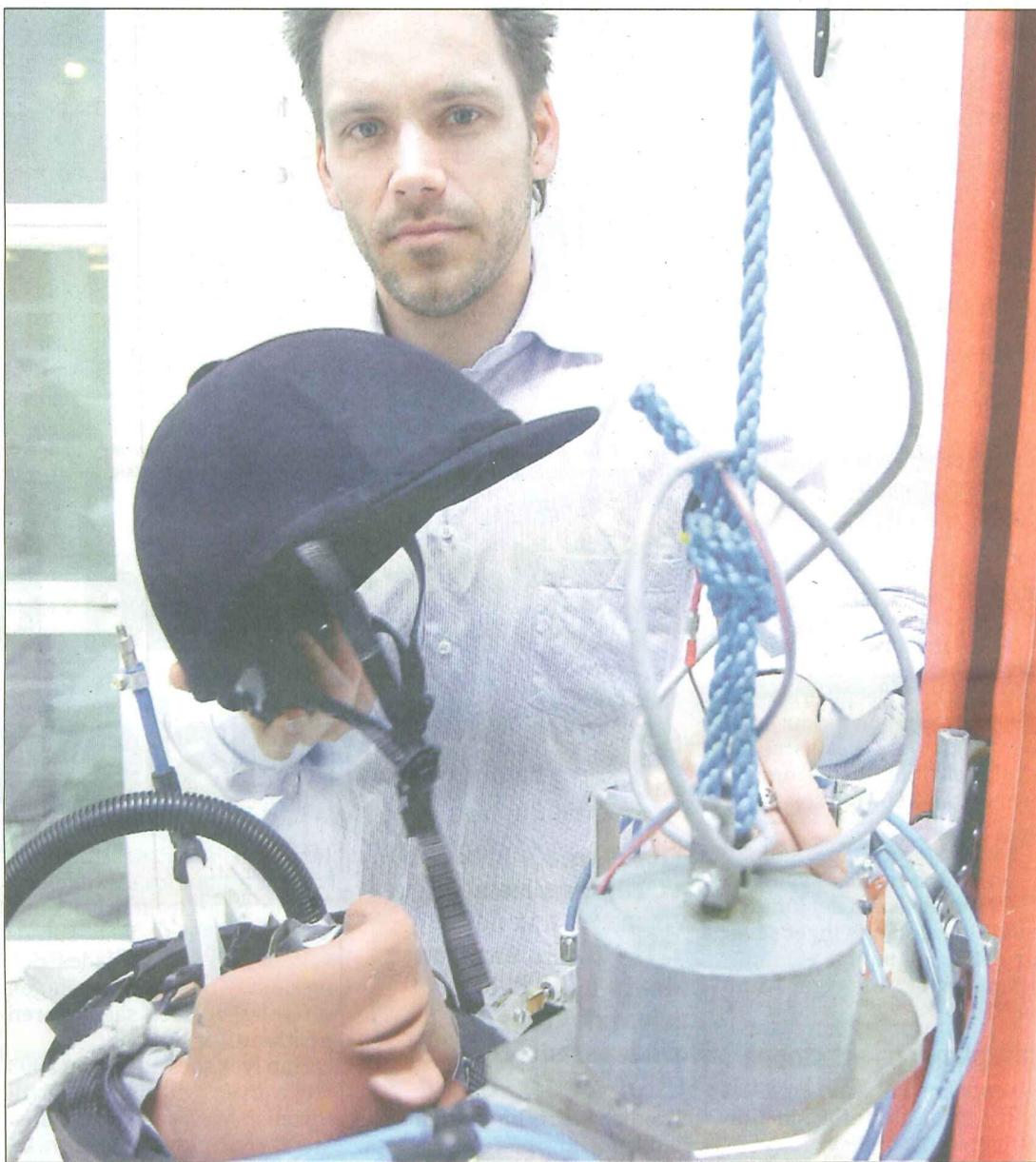
Med förhoppning att rädda liv. För att utveckla en ny ridhjälm har forskaren och uppfinnaren Peter Halldin arbetat med datasimulering av hjärnskador. I en testutrustning har Mips-hjälmen fått krascha mot en rörlig vägbana. FOTO: MAGNUS HARTMAN
