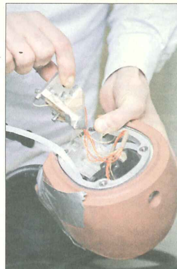
Peter Halldin med den konstgjorda hjärnan som har en mängd mätpunkter och används vid hjälmtestet.
