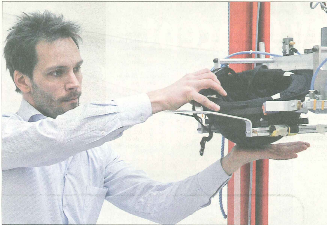
Civilingenjören Peter Halldin testar den nykonstruerade hjälmen med ett inbyggt glidskikt, uppbyggt ungefär som den mänskliga hjärnan.
